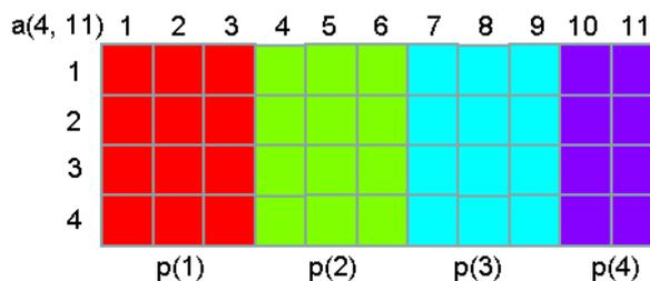
図 11 2 次元配列の 4 つの抽象プロセッサ上への 1 次元 BLOCK 分散
